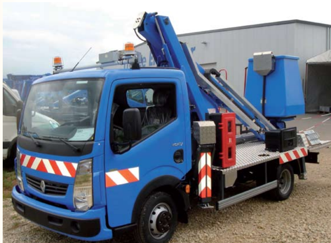
Tämä Maxity on saanut tehtäväkseen kuljettaa ns. nostolavaa, jolla uutterat työmiehet pääsevät korkeuksiin asentamaan vaikkapa tiivisteitä seinän saumoihin tai vaihtamaan valaisinten lamppuja.
