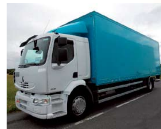
Isompi Midlum, 270 hv ja kokonaispaino 18 tonnia, päällirakenteenaan umpikaappi.
